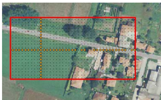
Figura 6: la griglia di riferimento e i punti battuti per la scala 1:2000
