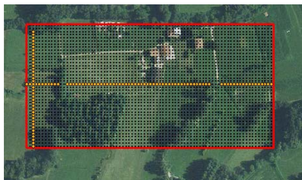
Figura 3: la griglia di riferimento e i punti battuti per la scala 1:5000
