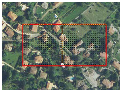
Figura 2: la griglia di riferimento e i punti battuti per la scala 1:2000
