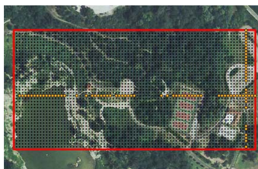
Figura 10: la griglia di riferimento e i punti battuti per la scala 1:5000
