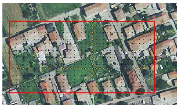
Figura 9: la griglia di riferimento e i punti battuti per la scala 1:2000
